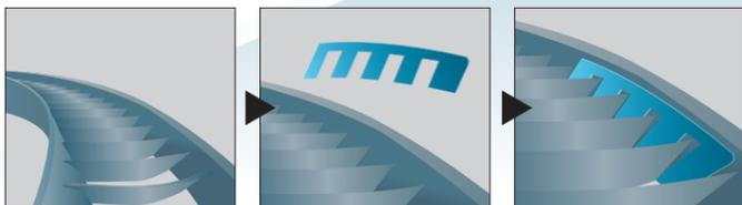
FUJIFILM peut concevoir et fournir des formes et des tailles personnalisées de plaques d'imagerie en fonction des besoins d'inspection de chaque client.
